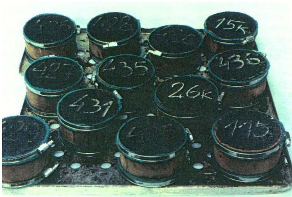
Rysunek 8.2. Widok próbek walcowych przygotowanych do starzenia długoterminowego
