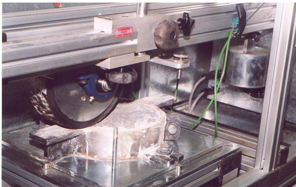
Rysunek 9.2 Widok próbki podczas badania koleinowania (w pracy badano próbki prostopadłościennie, inne niż fotografii)
