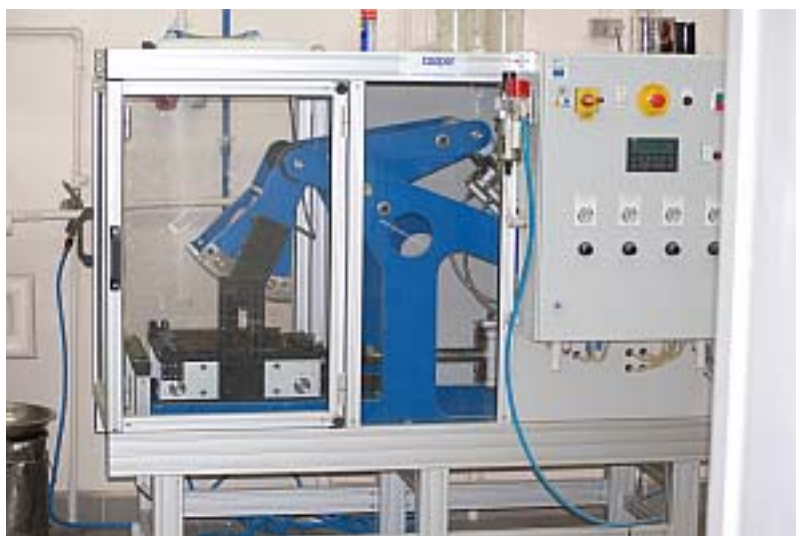
Rysunek 9.1 Zagęszczarka walcowa wykorzystana do wykonania próbek do koleinowania (na zdjęciu brak formy)
